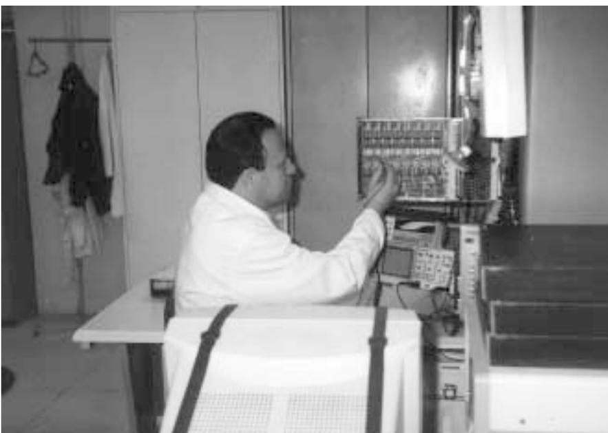
Abb. 1: Fehlerhafte Module von Telefonvermittlungsanlagen werden geprüft und repariert.
